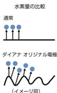
本商品で使用しているダイアナオリジナルの電極板は、通常よりも厚めに作っているため、水素を発生させる時間が長くなり電極寿命を長くすることが可能となりました。(卓上タイプ：3,500時間、アンダーシンクタイプ：4,500時間)<sup>※</sup>
